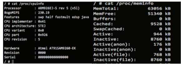
그림 11. cpu, memory information of embedded linux cpu information에 arm926ej-s core와 atmel at91sam9xeek(at91sam9290-ek와 동일)의 hardware가 잘 표시됨을 확인할 수 있다.
